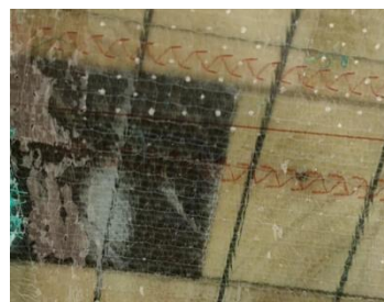
图 3 朽木导致的灌注缺陷
